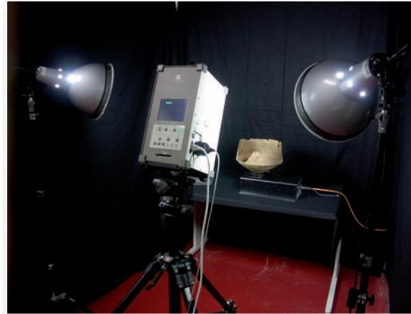
Für die neue, dreidimensionale Funderfassung und -dokumentation wurde im Landesamt für Archäologie Sachsen ein Scannerarbeitsplatz eingerichtet, an dem pro Tag bis zu 30 Objekte digitalisiert werden können. Dazu wurde das „Labor“ mit dem 3D-Scanner VI-910 der Firma Konica Minolta, sowie der Aufnahmesoftware „PET“ (Konica Minolta) und dem Modellierungstool „Geomagic Studio 9“ (Geomagic GmbH) ausgestattet.
